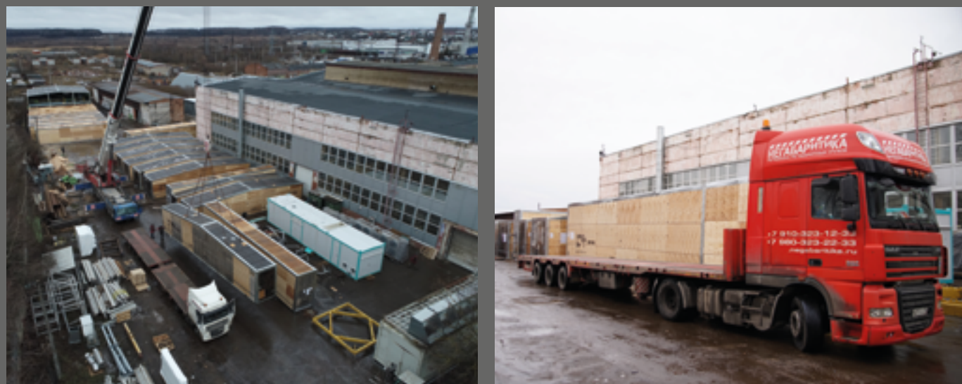
Отгрузка двух котельных производилась в 8 этапов за 60 дней. Было задействовано: 48 еврофур и 54 низкорамника.
